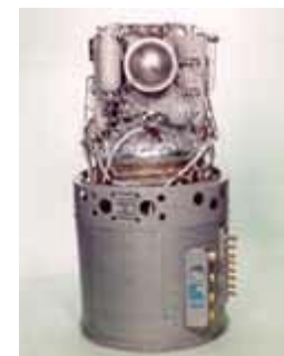
Cella a combustibile dell' Apollo della NASA
