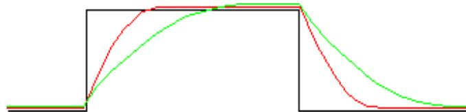
Nella prima delle due situazioni rappresentate è presente solo l'induttanza  $L_a$  e la resistenza  $R_a$  equivalenti dell'avvolgimento, parametri non modificabili senza costruire un nuovo motore; il tempo necessario perché la corrente arrivi al suo massimo dipende dalla già citata formula:
